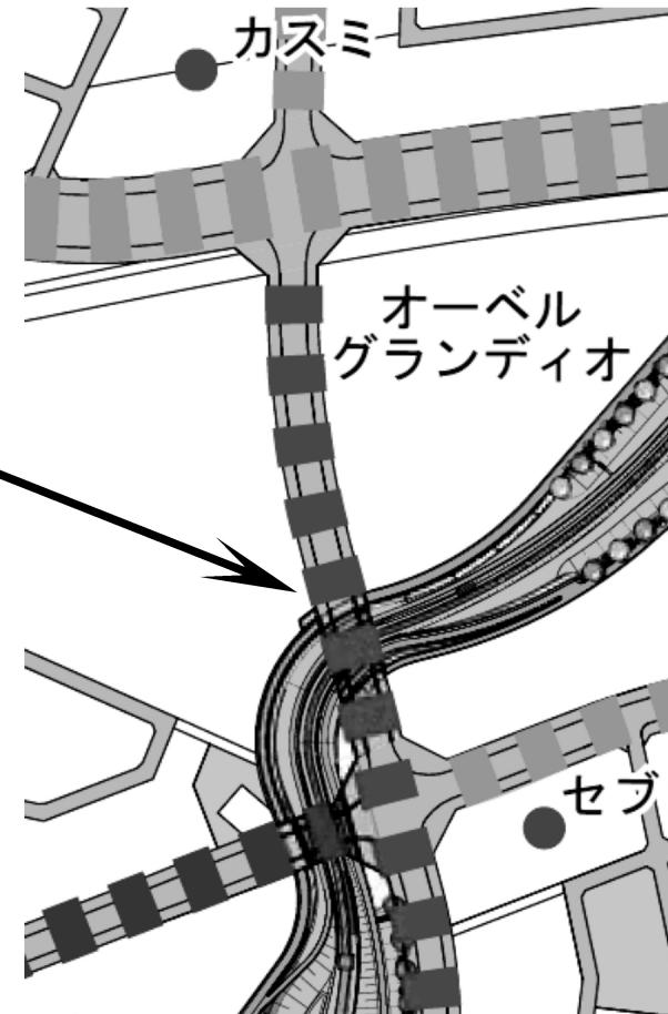
大堀川の上に架かった橋のそばに大きなくぼみがあり、雨が降るたびに大きな水たまり（○の囲み部分）が…。交通量が増大し、道路と橋の接続部分に段差が生じたことが原因です。
